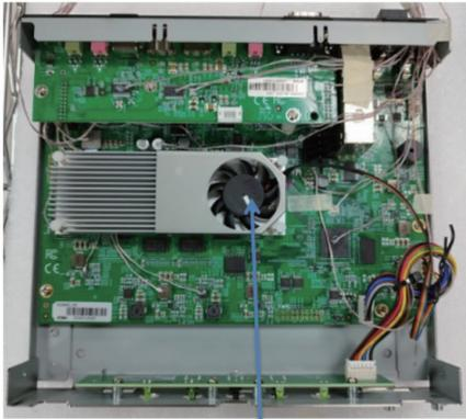
KX9980 減少單風扇設計，僅使用散熱風扇模組，減少主機輸出功耗 3.1% (原總功耗 44.9W，實際功耗 43.5W，減少輸出功耗 1.4W)。
