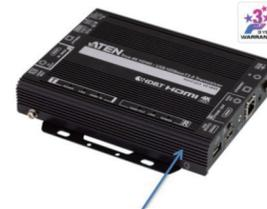
VE1843A 機種上蓋使用輕量材料 (AL)，上蓋重量除可減輕達 4% 並具有散熱功能 (原鐵上蓋重 240g，改為輕量材料 (AL) 230g，減少重量 10g)。
