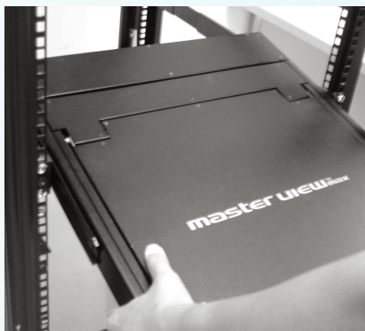
KVMドローをサイドマウントレールにスライドさせ、ラックに設置します。
