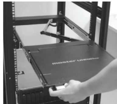
3) LCD KVM 스위치 / LCD 콘솔을 밖으로 밀어내면 설치가 완료됩니다.
