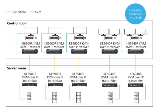
• **Estensioni KVM:** per il controllo senza ritardi di un computer da una workstation remota installata nel complesso.
