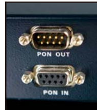
■ PON 입력 포트 - 데이지 체인을 지원하며, TCP/IP 제어가 가능한 모듈에 연결하거나, 로컬 관리자 콘솔로 사용
