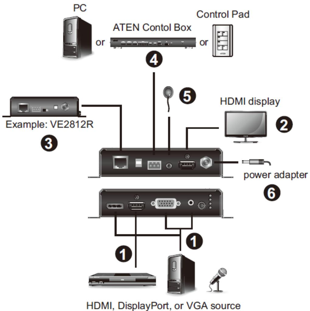
1. VE3912T의 DisplayPort, HDMI 또는 VGA 입력 포트와 DisplayPort, HDMI 또는 VGA 소스를 각각 알맞은 케이블을 이용해 연결하십시오. VGA 연결 시 사운드 전송을 위해 VGA 오디오 잭을 VE3912T의 오디오 입력에 연결해야 합니다.
