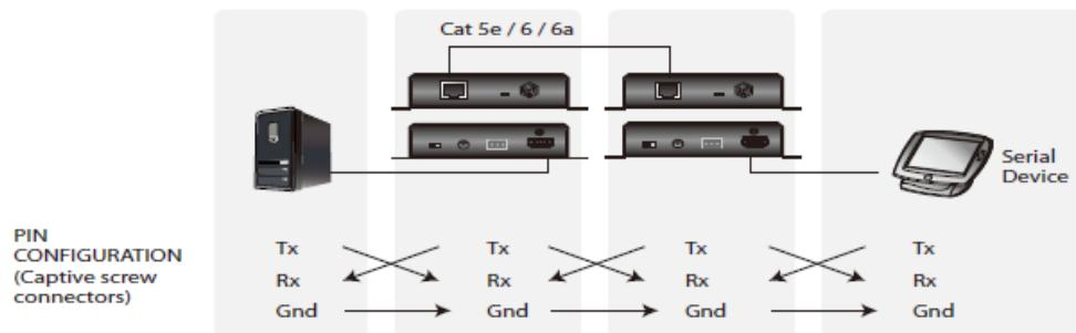
소스 장치에서 RS-232 신호는 VE3912T 수신 (Rx) 장치로 전송 (Tx)됩니다; 호환가능한 ATEN 비디오 수신기는 디스플레이 장치 (Rx)에 신호를 전송합니다. (Tx)
