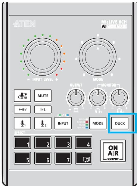
2. 適用したら、ミキサーの入力3や4で音楽を再生しながら、接続されたマイクを通して話してみてください。入力3と4の音量は、発言時に自動的に下げられます。
