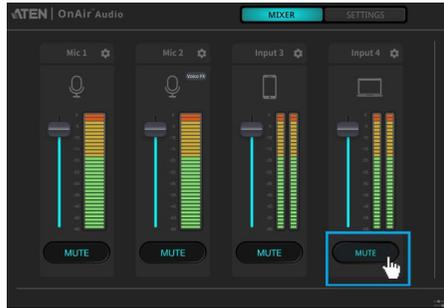
2. 使用するすべてのオーディオ・トラックのミュートが解除されたら、必要に応じて各トラックの音量を調整してください。
