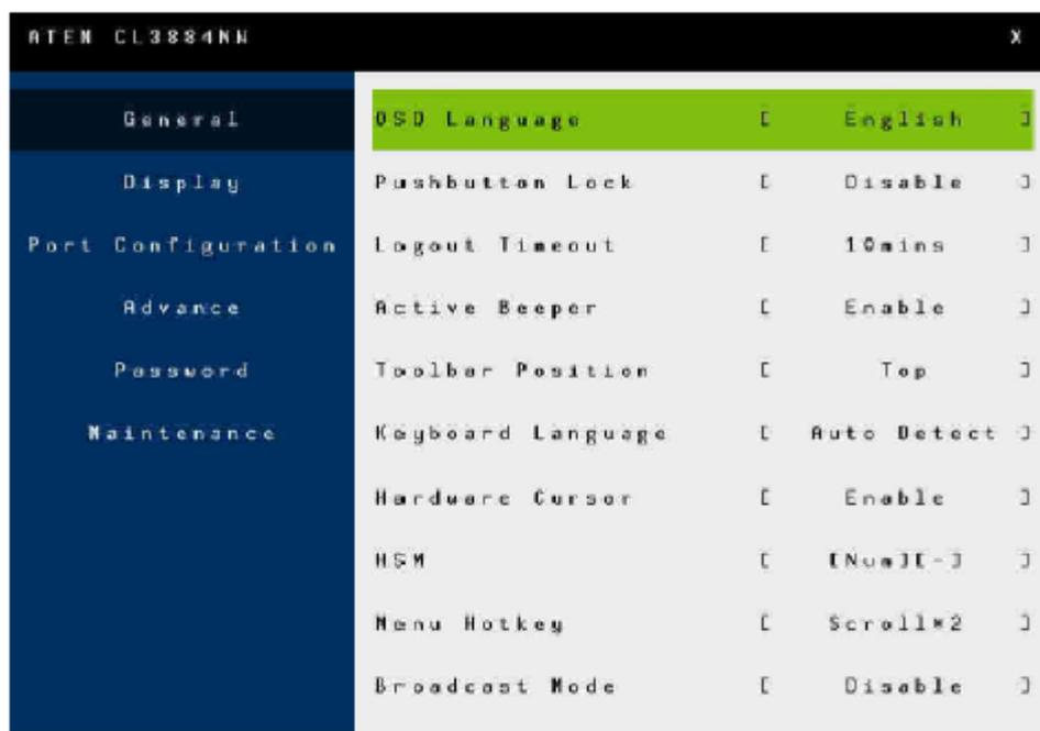
OSD 機能は、OSD の設定と操作に使用されます。例えば、任意のポートに素早く切り替えたり、選択したポートをスキャンしたり、表示するリストを制限したり、ポートをクイックビューポートとして指定したり、ポート名を作成または編集したり、OSD 設定を調整したりすることができます。各種設定については次に説明します。また、デフォルト設定は太字で表示されます。
