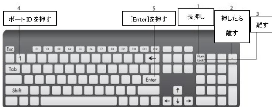
ポートに接続されているコンピューターに切り替える場合は、手順 4 のポート ID (1、2、3、4) を適宜置き換えて、操作を繰り返してください。ホットキーの詳細については、p.87「キーボードによるポート操作」を参照してください。
