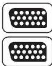
本製品はKVMポートまたはコンソールポートに対してSPHDコネクタを使用しております。コネクタの形状に改良を加えておりますので、専用のKVMケーブルのみ製品に接続することが可能です。
